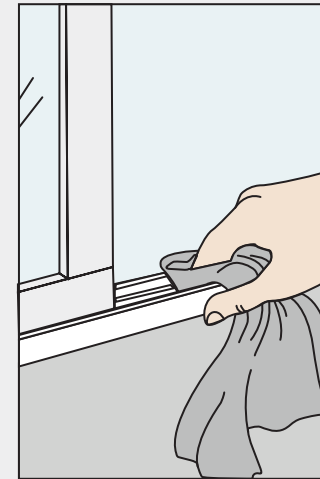
FIGURA # 22. LIMPIEZA DE LOS RIELES DE PUERTAS Y VENTANAS
